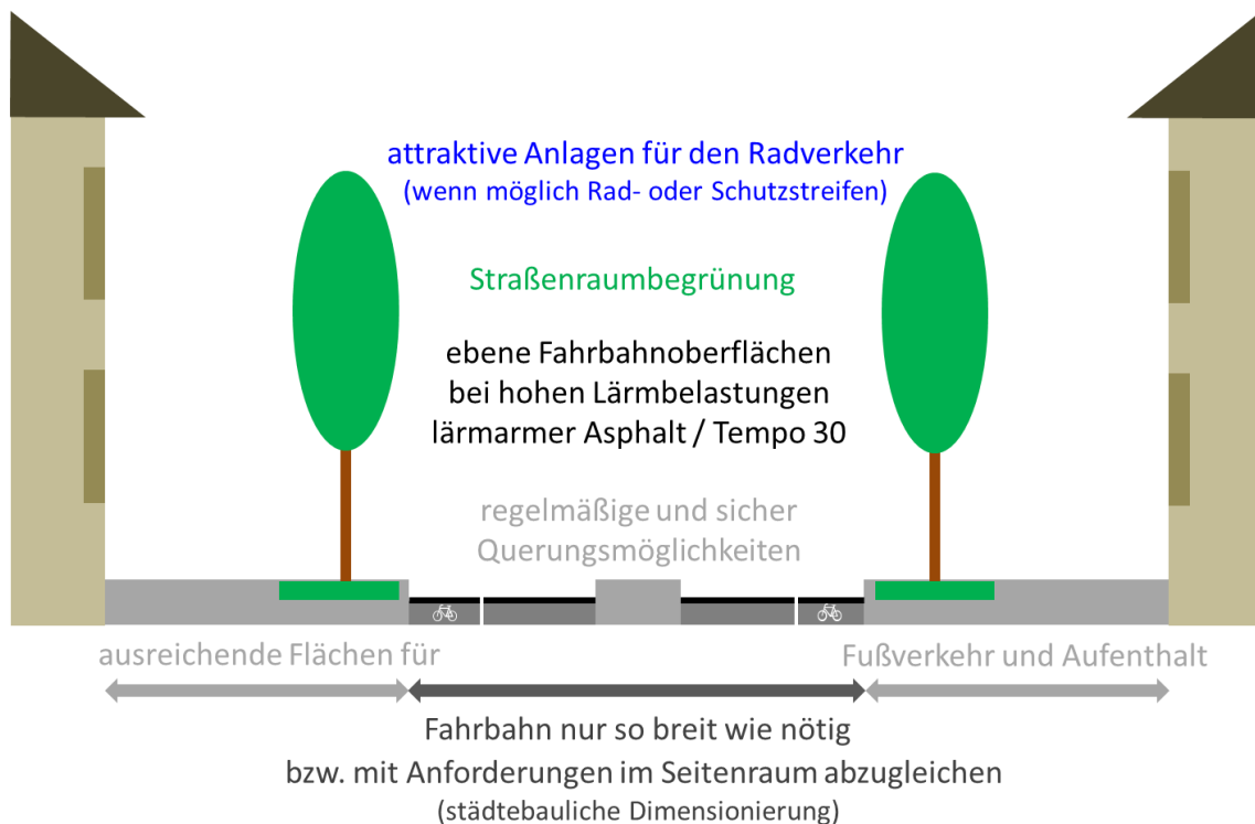
Abb. 21 idealtypischer Straßenquerschnitt im Sinne der Lärminderung
